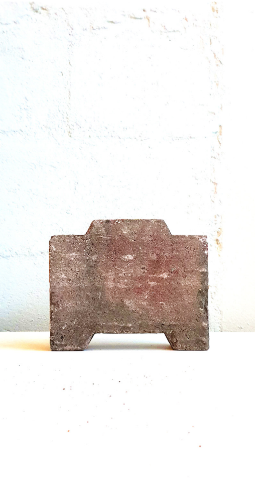
Un des 30 000 pavés autobloquants réutilisés sur site.
