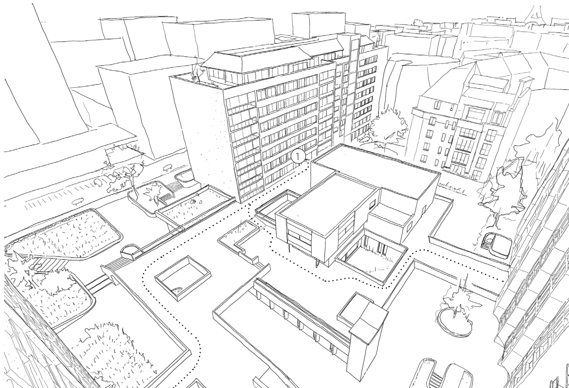
1995, avec la surélévation le patio Nord n'est plus ensoleillé. Les accès PMR aux logements via l'ascenseur d'un immeuble sur rue (1) sont maintenus.
